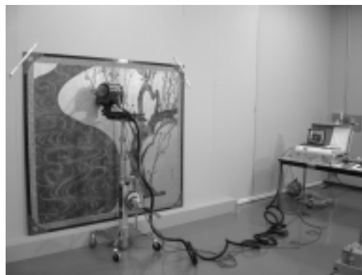
写真1 ポータブル蛍光X線分析装置による紅白梅図屏風調査の様子
